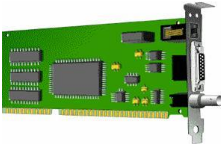
Gambar Kartu Jaringan Ethernet Dari Atas Ke Bawah : konektor RJ-45, konektor AUI, dan konektor BNC
